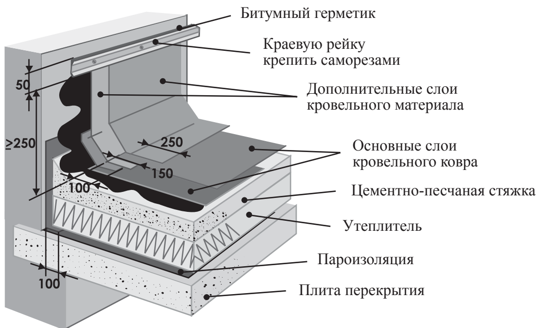
Рис. 22. Примыкание кровельной системы к вертикальной поверхности.
